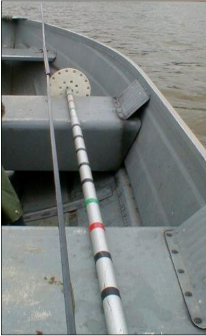
Abb.5.2-88 : Mechanisches Sondiergestänge (links im Foto) zur Erfassung der Schlammmächtigkeit
